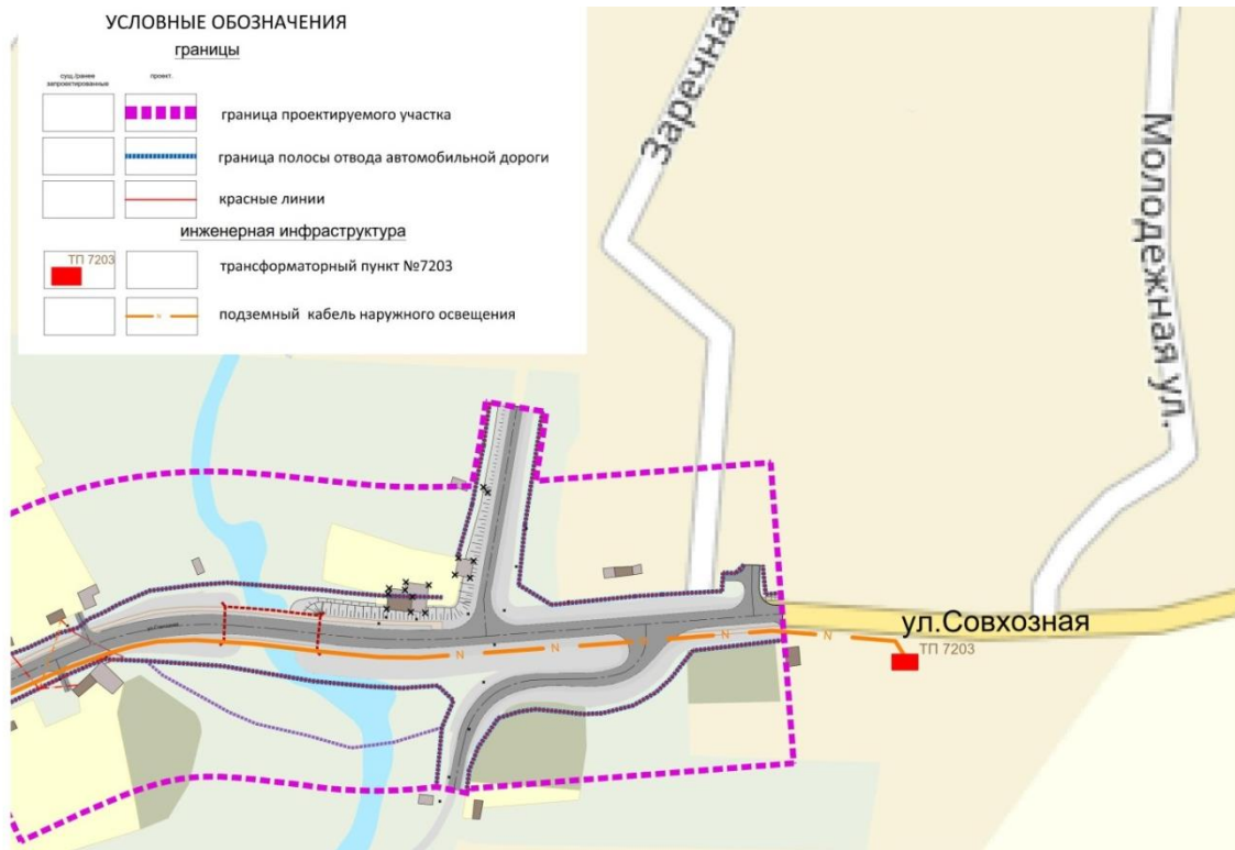
Рисунок 3 Схема трассы кабеля наружного освещения за границами проектирования
