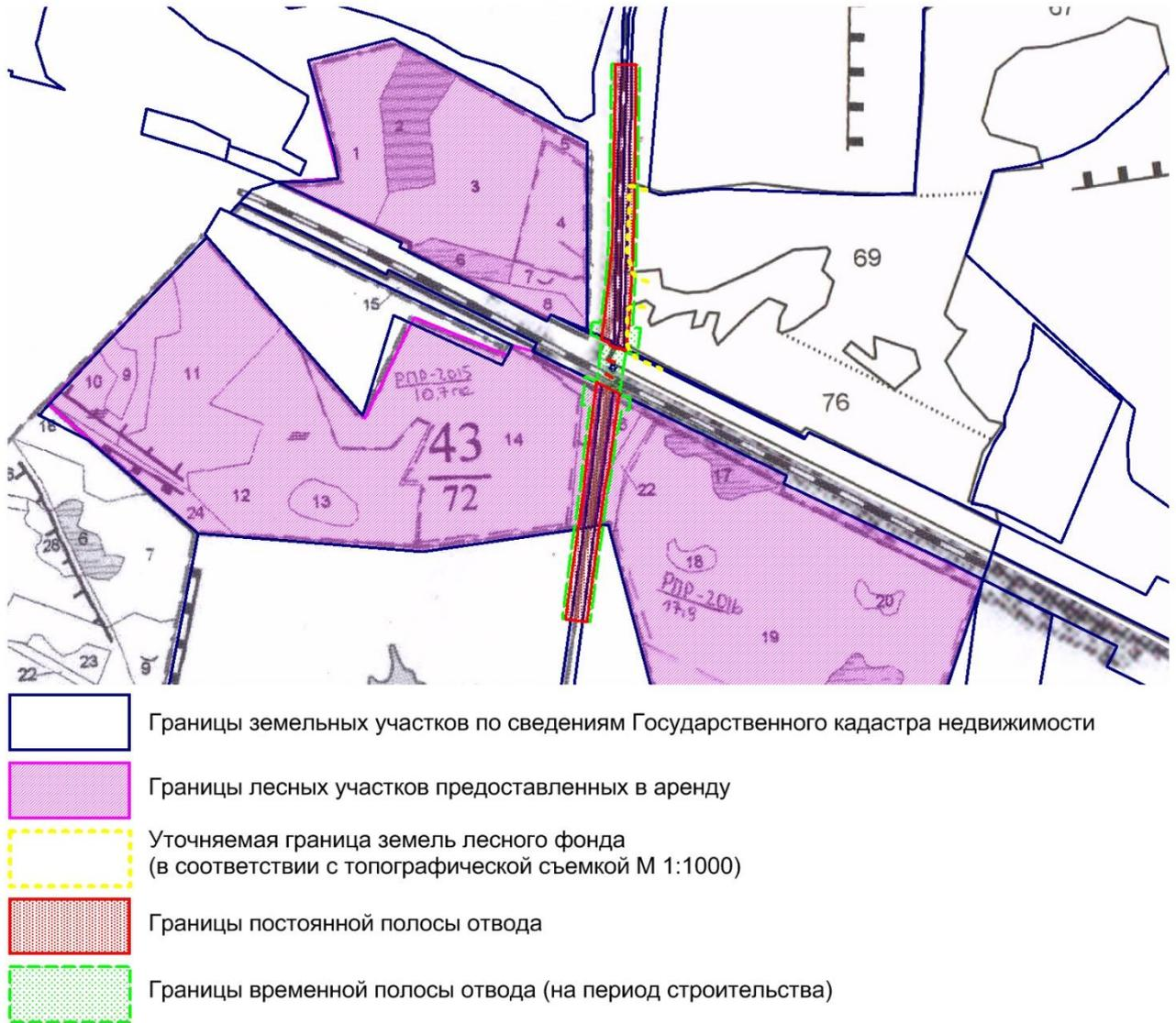
Рис. 3. Схема участков лесных земель, предусмотренных под постоянную и временную полосы отвода линейного объекта
