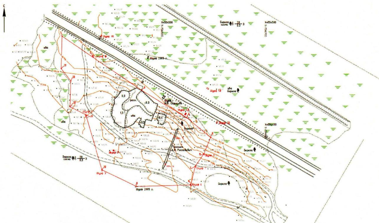
2. Координаты поворотных точек во Всемирной геодезической системе координат (далее – WGS-84) и местной системе координат Свердловской области (далее – МСК-66) определены геодезическим методом и приведены в таблице, погрешность определения координат составляет 0,1 метра.
