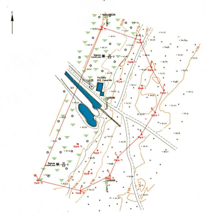
2. Координаты поворотных точек во Всемирной геодезической системе координат (далее – WGS-84) и местной системе координат Свердловской области (далее – MCK-66) определены геодезическим методом и приведены в таблице, погрешность определения координат составляет 0,1 метра.
