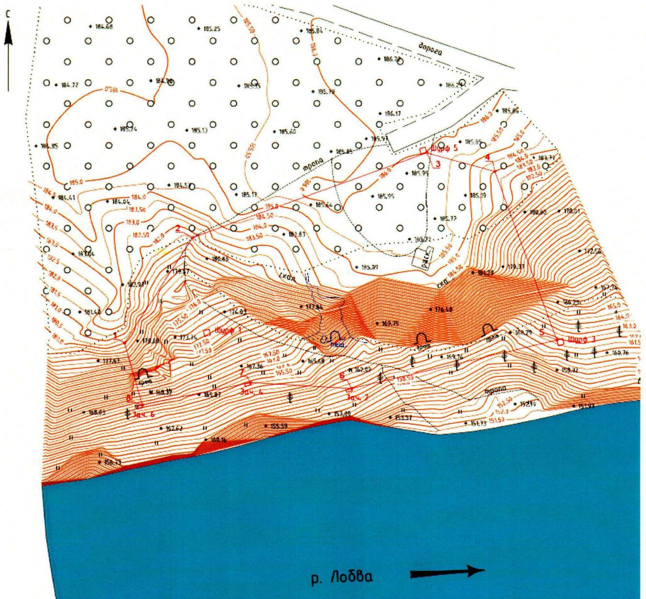
2. Координаты поворотных точек во Всемирной геодезической системе координат (далее – WGS-84) и местной системе координат Свердловской области (далее – МСК-66) определены геодезическим методом и приведены в таблице, погрешность определения координат составляет 0,1 метра.
