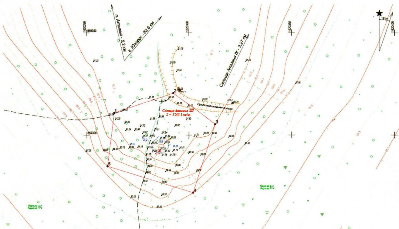
2. Координаты поворотных точек в местной системе координат Свердловской области (далее – МСК-66) определены геодезическим методом и приведены в таблице, погрешность определения координат составляет 0,1 метра.
