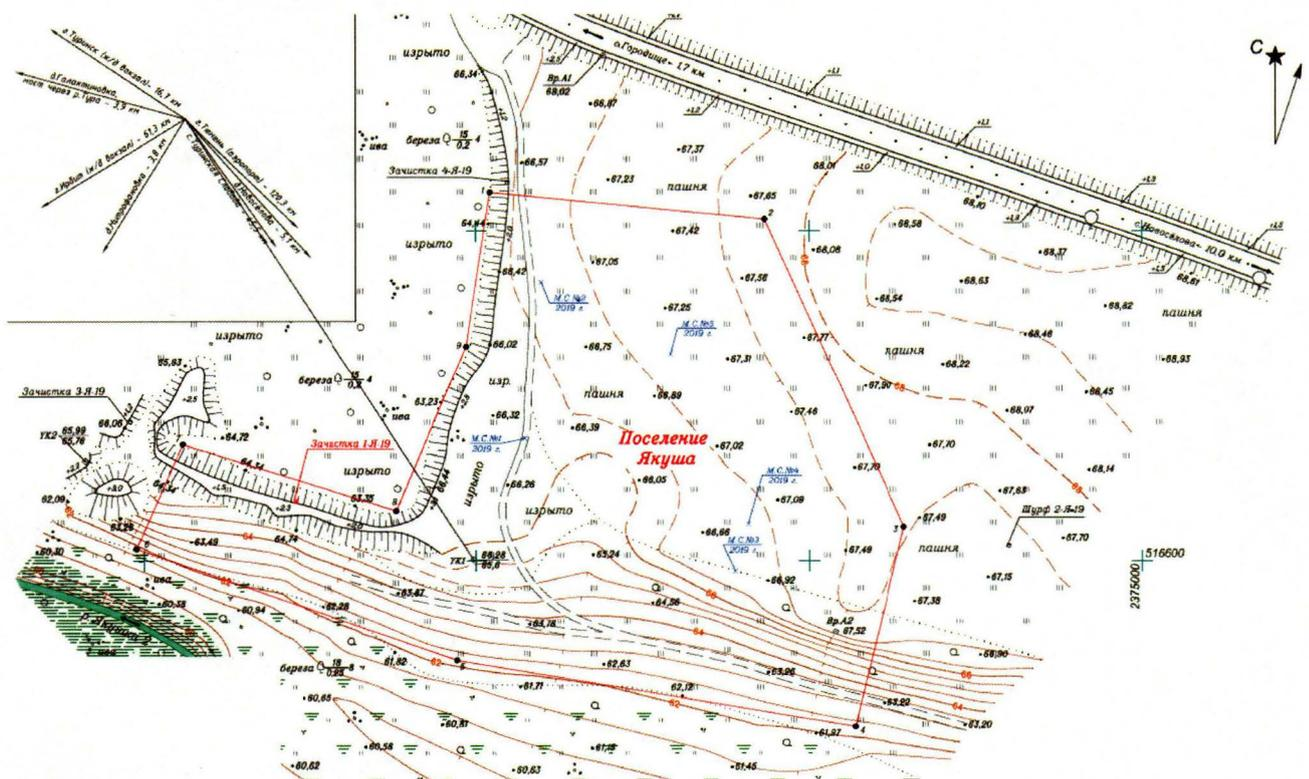
2. Координаты поворотных точек в местной системе координат Свердловской области (далее – МСК-66) определены геодезическим методом и приведены в таблице, погрешность определения координат составляет 0,1 метра.
