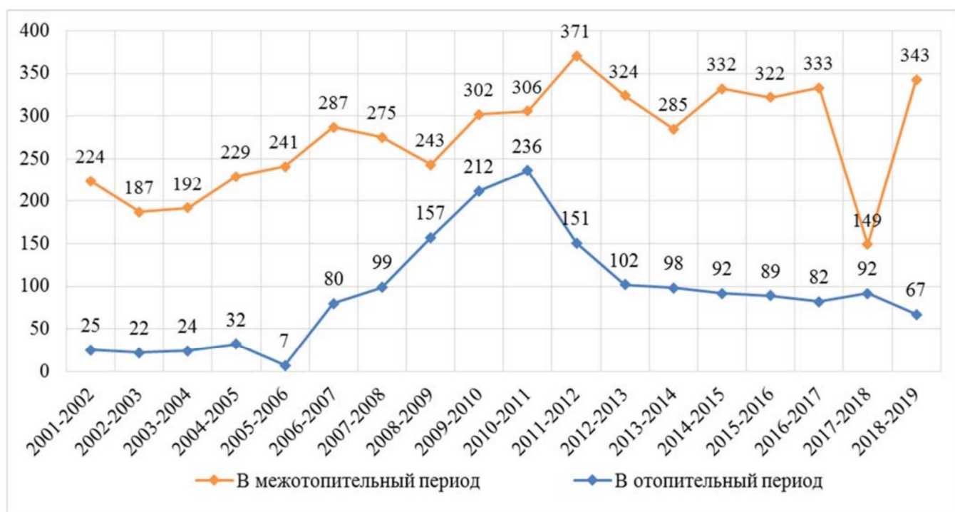
Рисунок 20. Количество повреждений в магистральных тепловых сетях АО «ЕТК»
