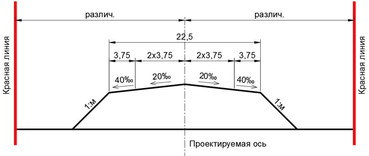
Рис. 1 Поперечный профиль автодороги
