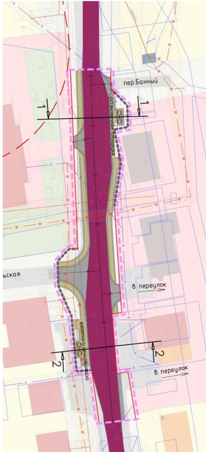
Рисунок 2 Схема размещения поперечных профилей
