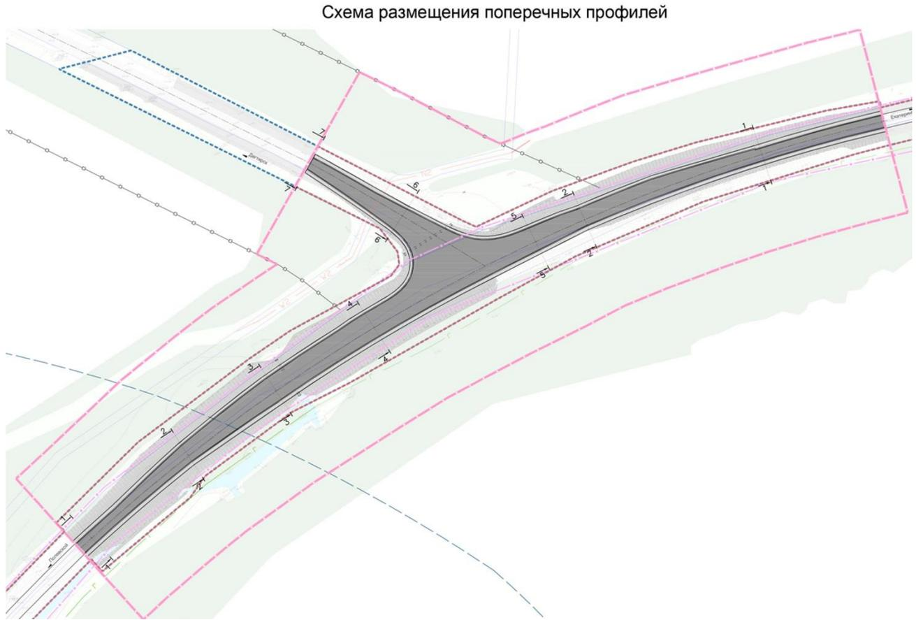
Рисунок 2 Схема размещения поперечных профилей
