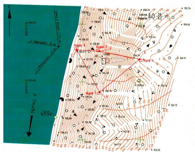
2. Координаты поворотных точек во Всемирной геодезической системе координат (далее – WGS-84) и местной системе координат Свердловской области (далее – MCK-66) определены геодезическим методом и приведены в таблице, погрешность определения координат составляет 0,1 метра.
