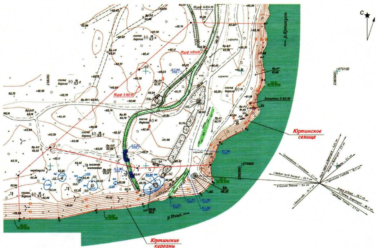
2. Координаты поворотных точек в местной системе координат Свердловской области (далее – МСК-66) определены геодезическим методом и приведены в таблице, погрешность определения координат составляет 0,1 метра.
